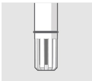
Figur 11.6 Prob med monterad o-ring klar för montage i mätrör.
