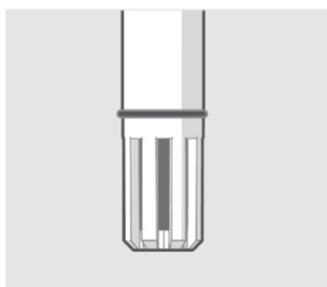
Figur 11.6 Prob med monterad o-ring klar för montage i mätrör.
