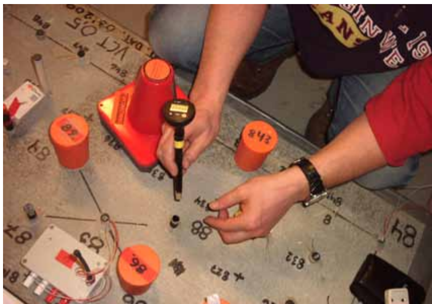
Montage av en RF-givare vid utförandet av borrhålmätning.
