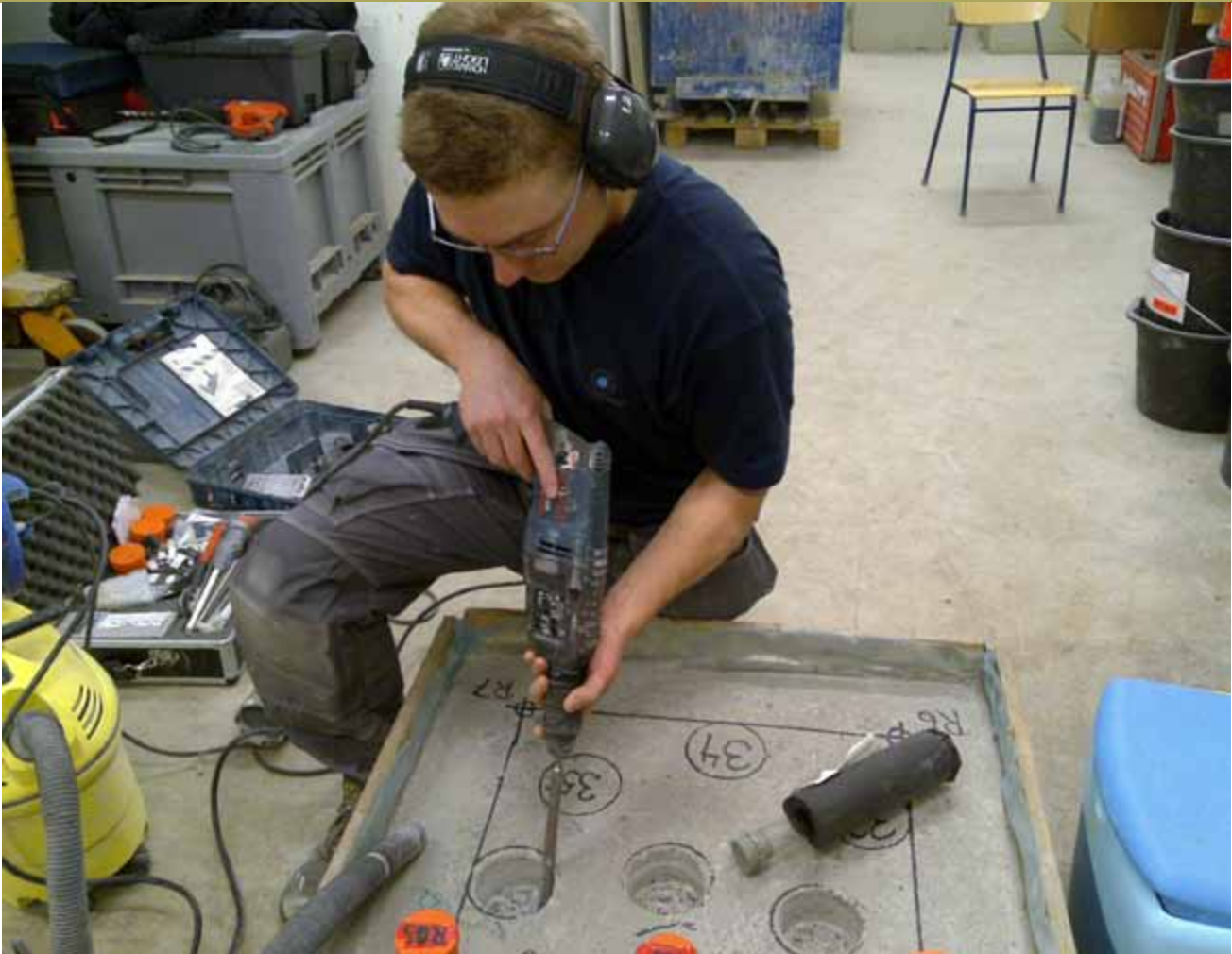
Linus Björnlund, Conservator AB, bilar ut betongbitar som placeras i ett provrör för att därefter utföra RF-bestämningen i ett "laboratorium". Mätmetoden kallas Uttaget prov.
