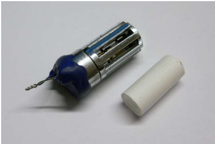
Figur 2.20 Kapad och förseglad HMP44-givare med sensor, gallerkydd och demonterat pappersfilter.
