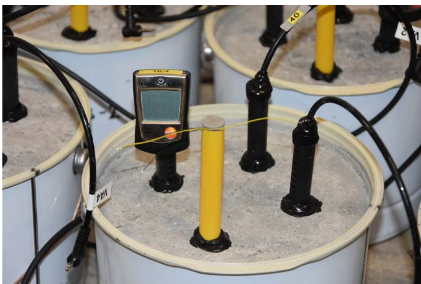
Figur 2.11 Exempel på provkropp under uttorkning med följande RF-givare monterade från vänster; 605 med tejp, HumiGuard, HMP44-Pico samt HMP110. Givarbenämningar enligt tabell 2.2.
