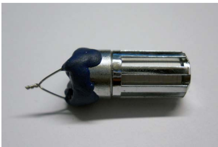
Figur 2.18 Kapad och förseglad HMP44-givare med sensor, gallerkydd och pappersfilter.
