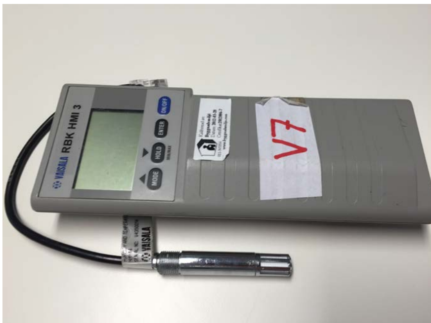
Figur 2.5 Vaisala HMI41 avläsningsinstrument samt tillhörande RF-givare HMP44 försedd med gallerskydd och pappersfilter.
