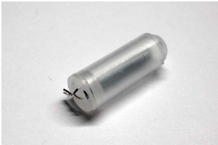
Figur 2.17 HumiGuard-givare med sensor och plasthölje.
