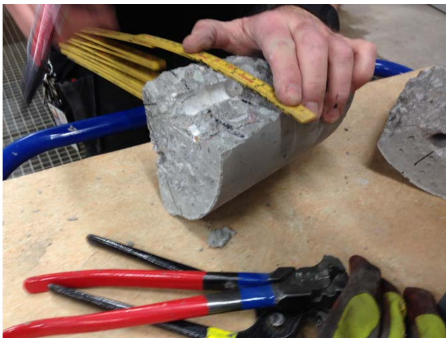
Figur 2.13 Provbit efter spräckning för vidare uttagning av provbitar från tre djup som anges från gjutytan.
