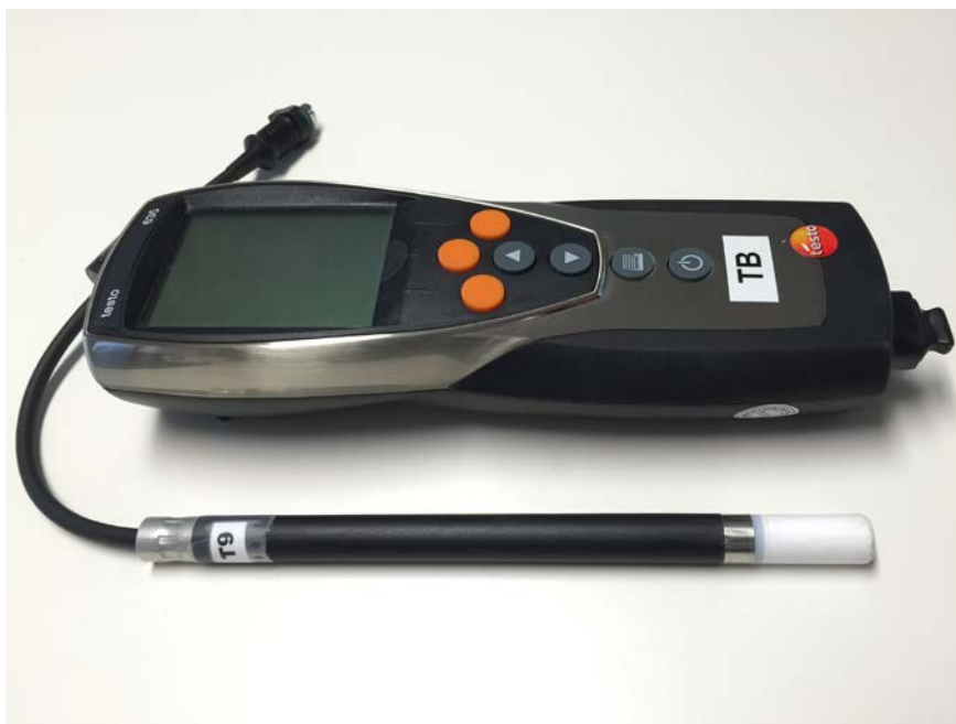
Figur 2.4 Testo 635 avläsningsinstrument samt tillhörande RF-givare, Testo 05726172, försedd med teflonfilter.
