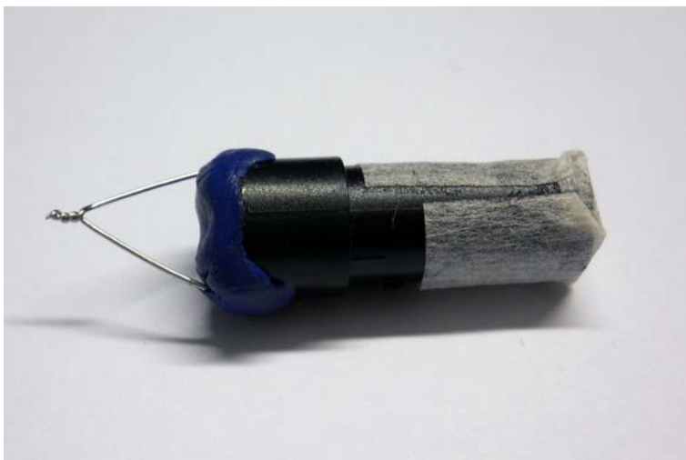
Figur 2.24 Kapad och förseglad 605-givare med sensor utan skyddshuv och försedd med tejp (Micropor 10x40mm).
