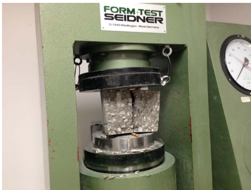
Figur 2.12 Proven spräcktes i hydraulisk press inför uttagning av provbitar för RF-mätning.
