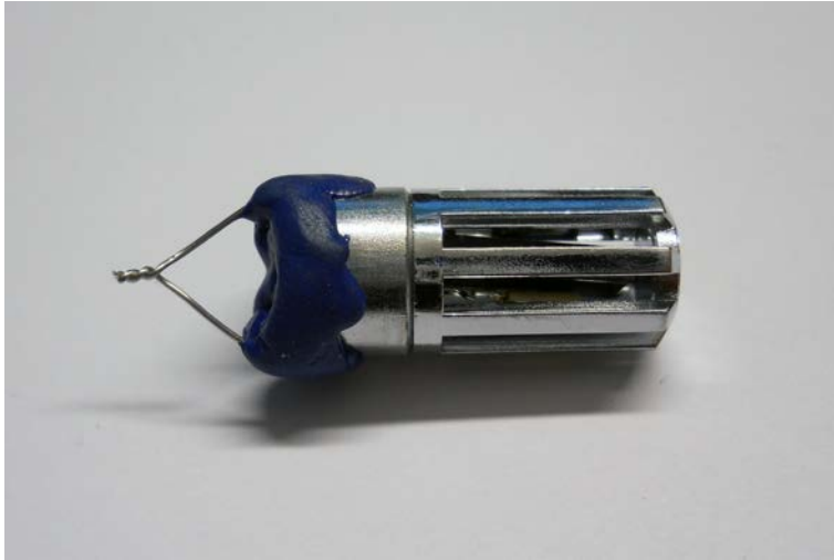
Figur 2.19 Kapad och förseglad HMP44-givare med sensor och gallerkydd utan filter.
