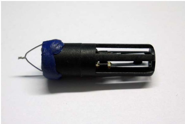
Figur 2.26 Kapad och förseglad 635-givare med sensor och öppet gallerskydd.
