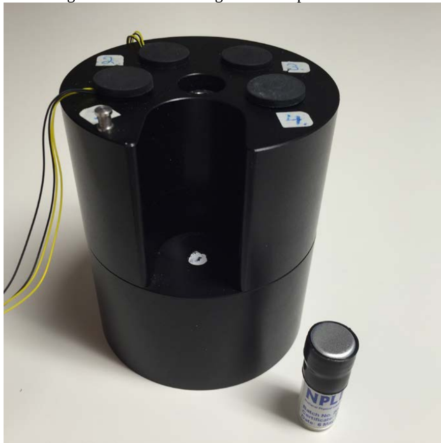
Figur 2.8 HumiGuard referensblock och referenscell som används för kontroll av RF-sensorernas drift under mätperioden.
