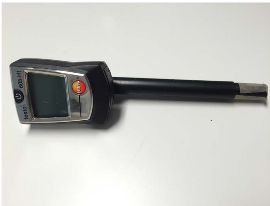
Figur 2.2 Testo 605-H1 försedd med tejp som skydd över RF-sensorn (fabrikat Scanpor 10x40 mm)
