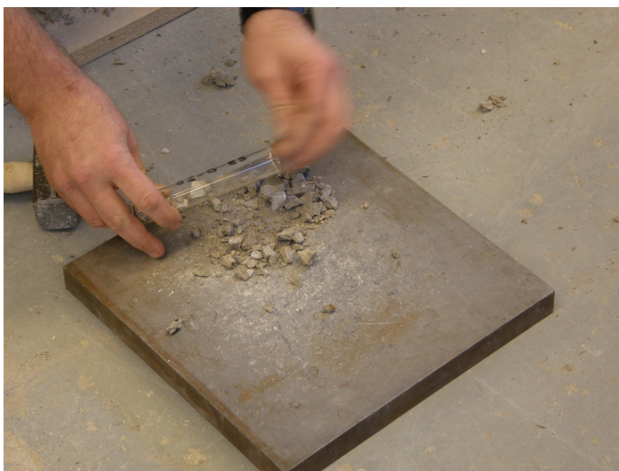
Figur 2.14 Uttagna provbitar från respektive djup placeras i glaströr som förseglas med gummikork i väntan på RF-mätning.
