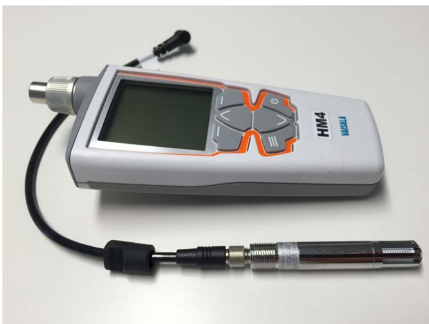
Figur 2.6 Vaisala HM40 avläsningsinstrument samt tillhörande RF-givare HMP110 försedd med gallerskydd och pappersfilter.
