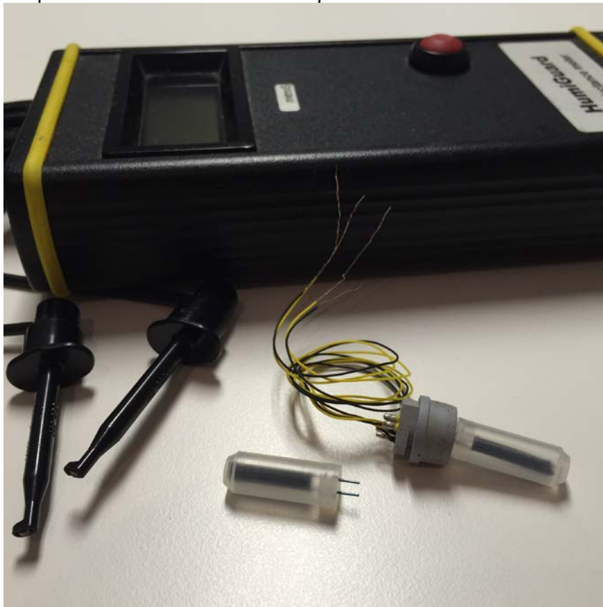
Figur 2.7 HumiGuard avläsningsinstrument med synlig display samt två tillhörande RF-givare med semitransparent plasthölje. Den högra sensorn är kopplad till en givarkontakt som används vid försegling av mätrör vid mätning i borrhål. Till vänster två anslutningsklämmor, med svart plasthölje, för anslutning till sensor vid avläsning.
