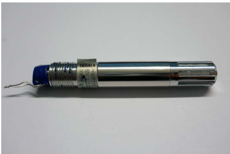
Figur 2.21 HMP110-givare med sensor, gallerkydd samt pappersfilter och förseglat kabeluttag i bakstycket.
