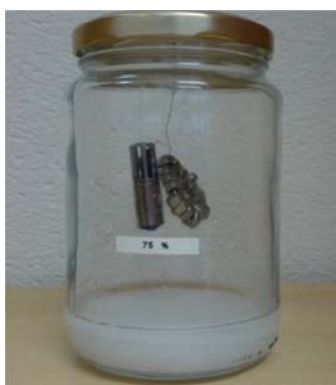
Figur 11. Vaisalasensor samt extratyngd som hänger i en glasburk med mättad saltlösning, NaCl.
