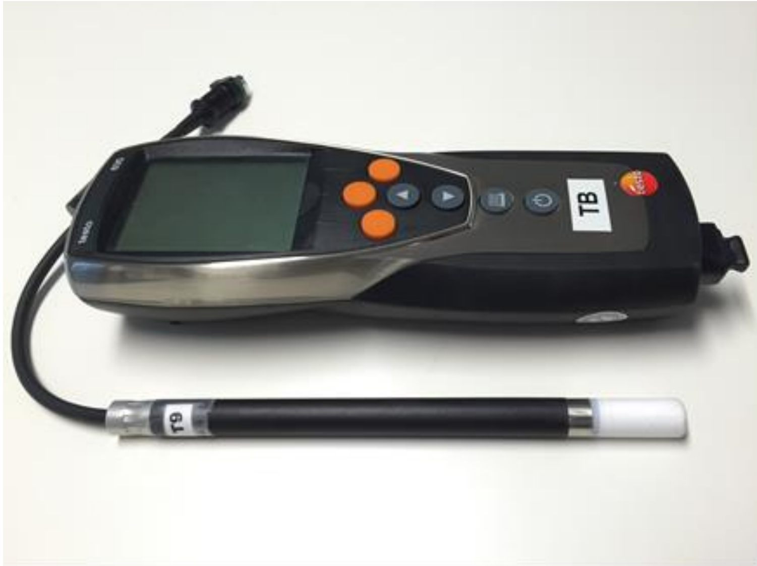
Testo 635 avläsningsinstrument samt tillhörande RF-givare, Testo 05726172, försedd med teflonfilter.
