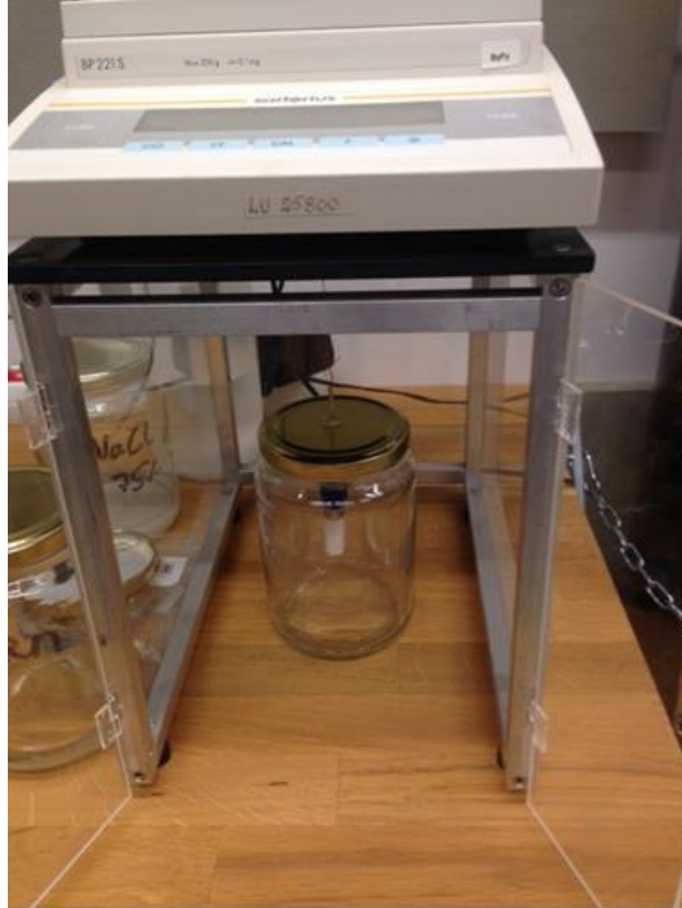
Vägning av RF-sensor vid pågående exponering för olika RF-nivåer med hjälp av mättade saltlösningar i glasburkar.
