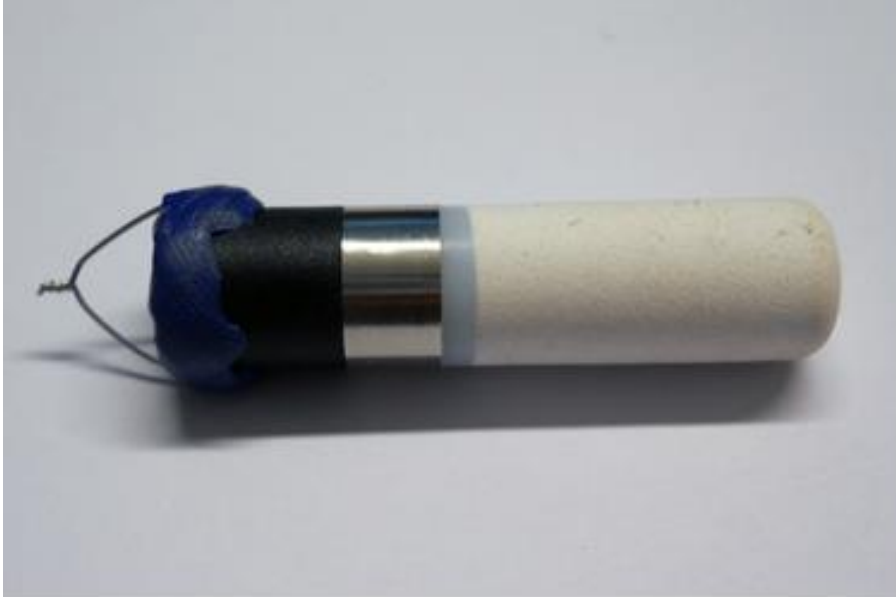
Kapad och förseglad 635-givare med sensor och teflonfilter.
