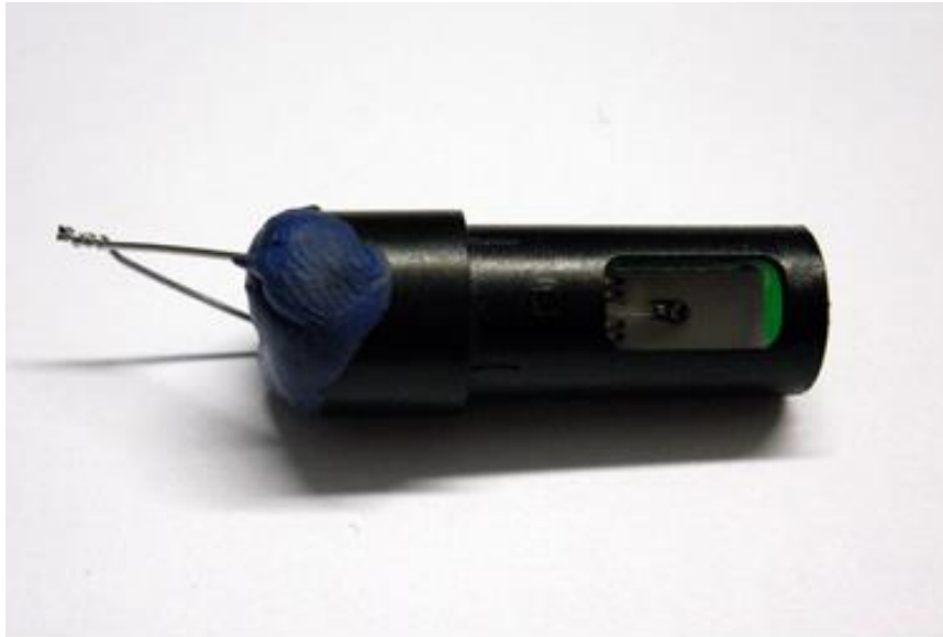
Kapad och förseglad 605-givare med sensor utan skyddshuv.
