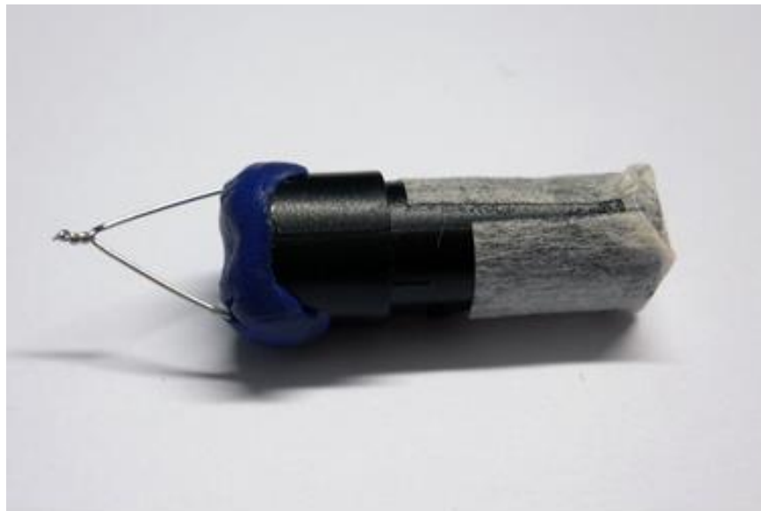
Kapad och förseglad 605-givare med sensor utan skyddshuv och försedd med tejp (Micropor 10x40mm).
