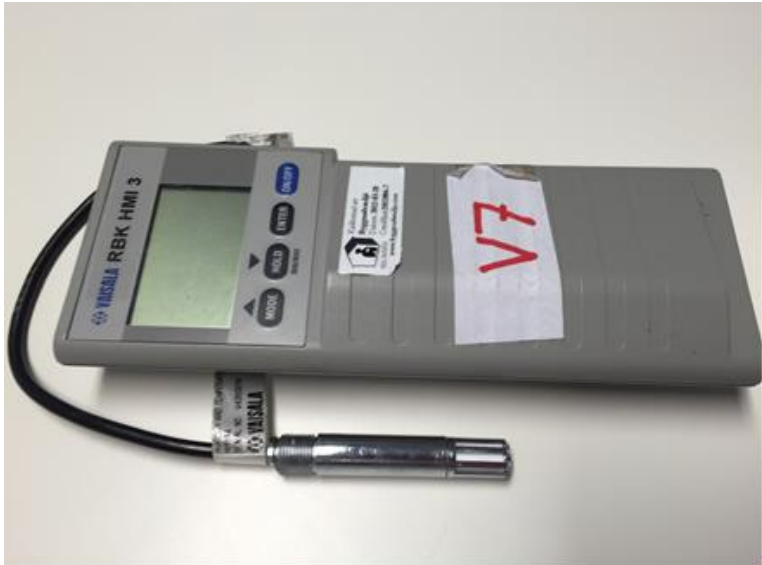
Vaisala HMI41 avläsningsinstrument samt tillhörande RF-givare HMP44 försedd med gallerskydd och pappersfilter.
