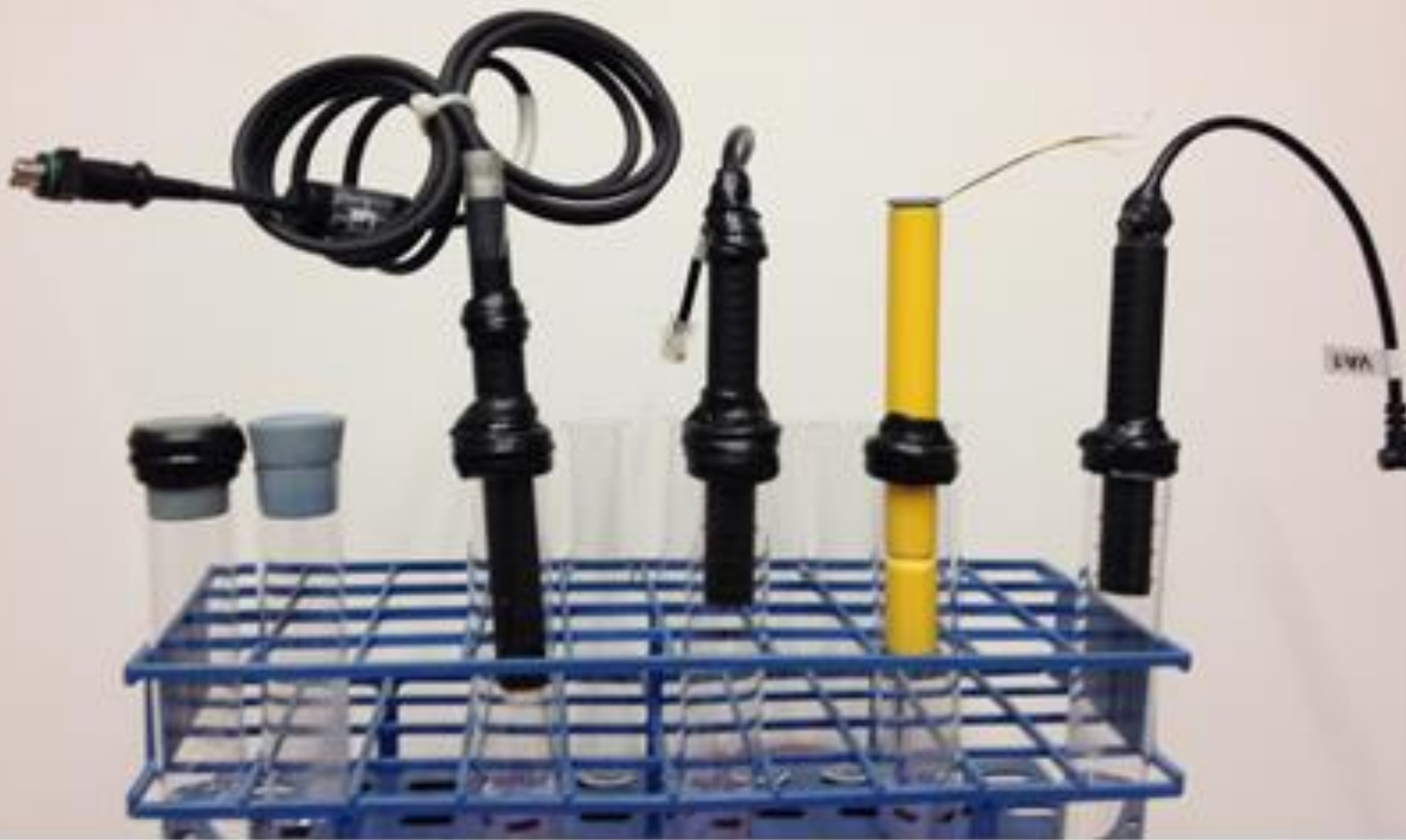
RF-sensorer monterade i provrör av glas fyllda med 1 cm vatten för kontroll av anslutningarnas ångtäthet.
